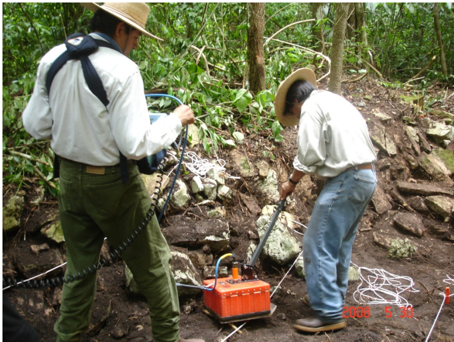
Adquisición de datos con georadar en modo continuo
