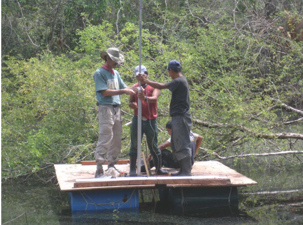
Figura 12.1. Extracción de núcleos en la aguada de El Palmar (Fotografía de Arturo Godoy).
