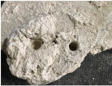
Figura 3.40. Perforaciones hechas en núcleo de piedra caliza para colocar pernos (Foto: M. Colín, PAET 2022).
