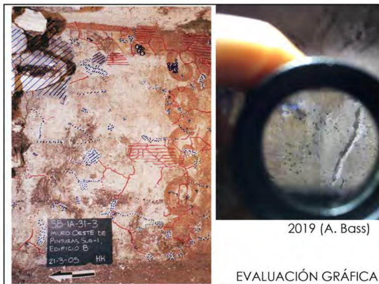
Figura 5.1. 5. Reevaluación con mapa de fisuras documentadas en temporada 2005 (fotografía por H. Hurst, 2005).
