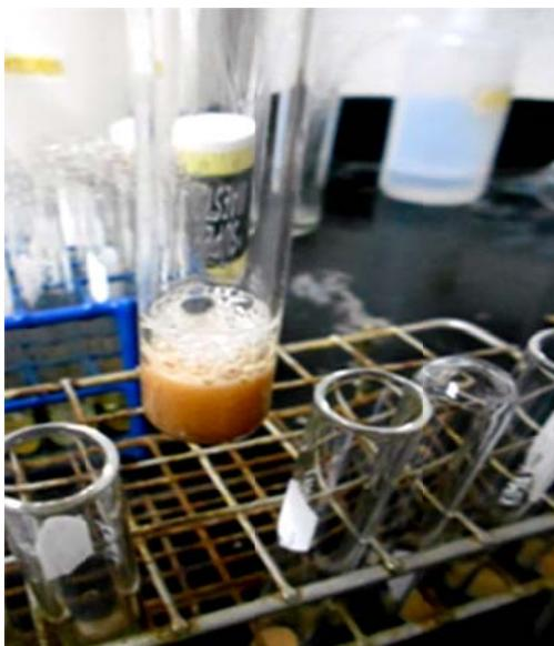
**Figura 6. Efervescencia en prueba de carbonatos.**
