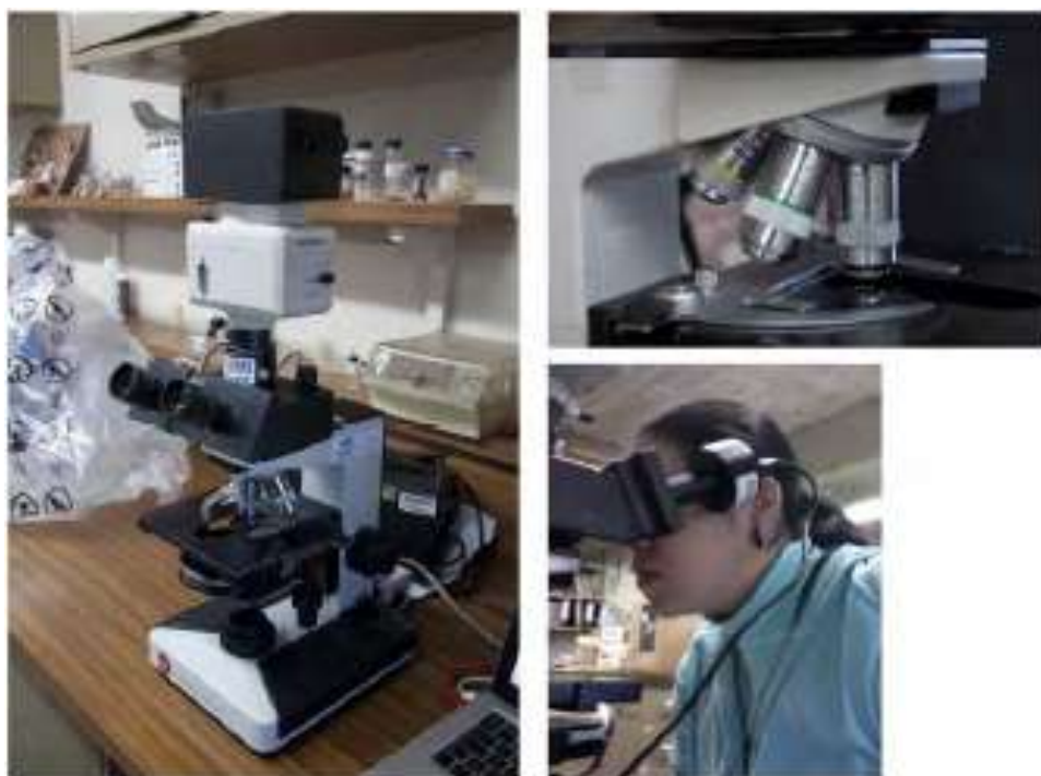
Figura 9.4 Microscopio Leitz Laborlux S, objetivos del microscopio y vista de la cámara fotográfica utilizada para tomar fotografías de las muestras (Fotos por C. Guirola)
