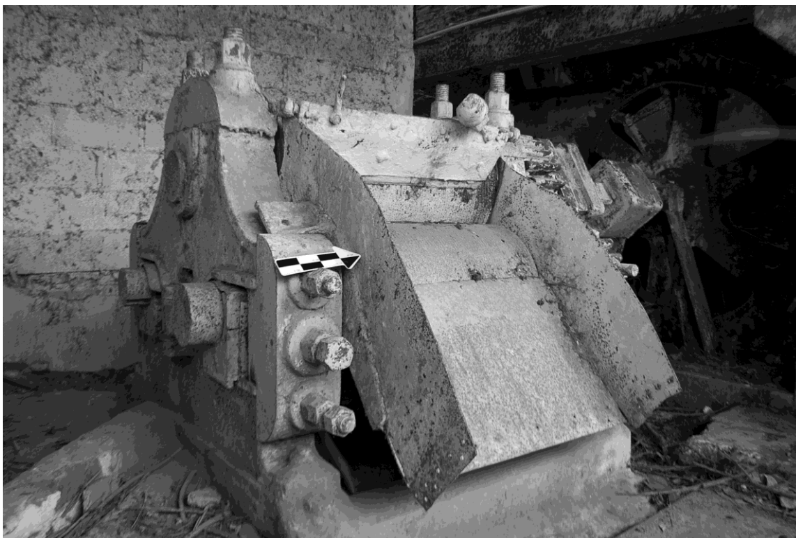
Figura 5 Molino en el que se extraía el jugo de caña.
