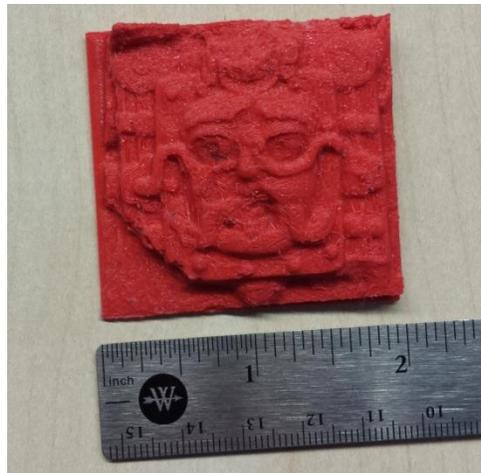
Figura 9.6. Impresión en tres dimensiones; tamaño: 50mm x 48.39mm x 11.82mm (Cortesía USC).
