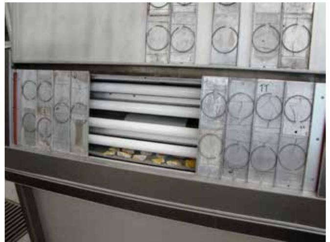
FIGURA 96. Muestras dentro de la cámara (MBR).
