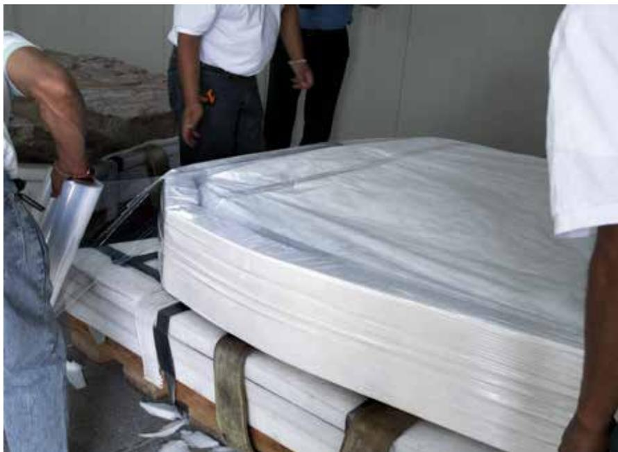
FIGURA 160. Sujeción del embalaje con película autoadherible (JMG).
