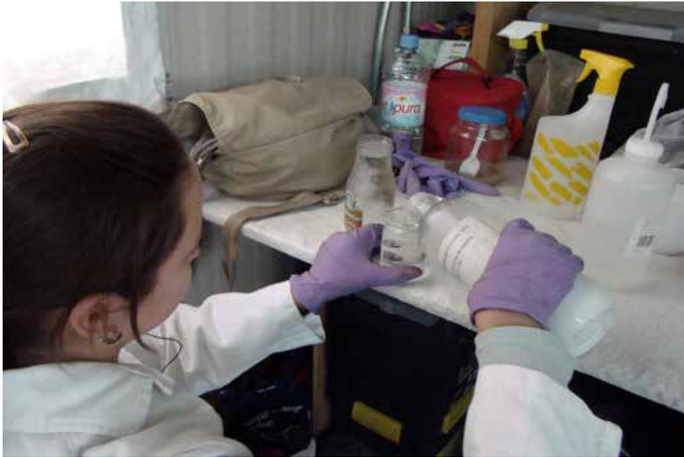
FIGURA 142. Preparación del consolidante KSE 300<sup>®</sup> 1:1 en alcohol etílico (MBR).
