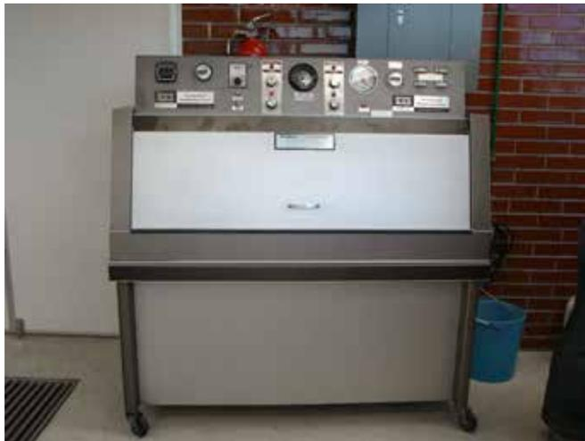
FIGURA 95. Cámara de envejecimiento acelerado (CBM).
