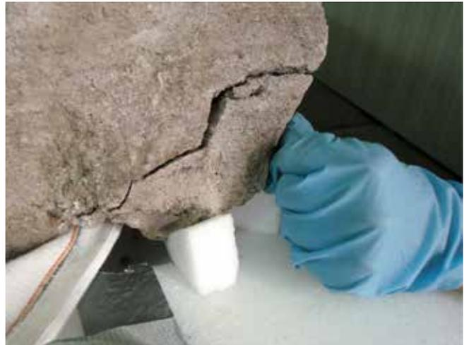
FIGURA 86. Proceso de unión con resina epóxica (CML).
