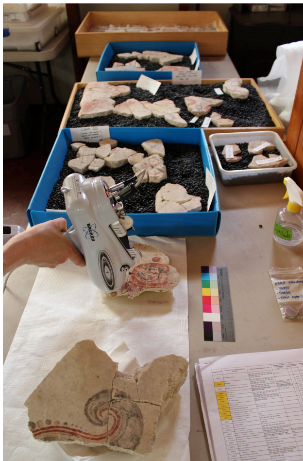
Figura 30. Uso de fluorescencia de rayos X portatil (Fotografía A. Bass 2015)
