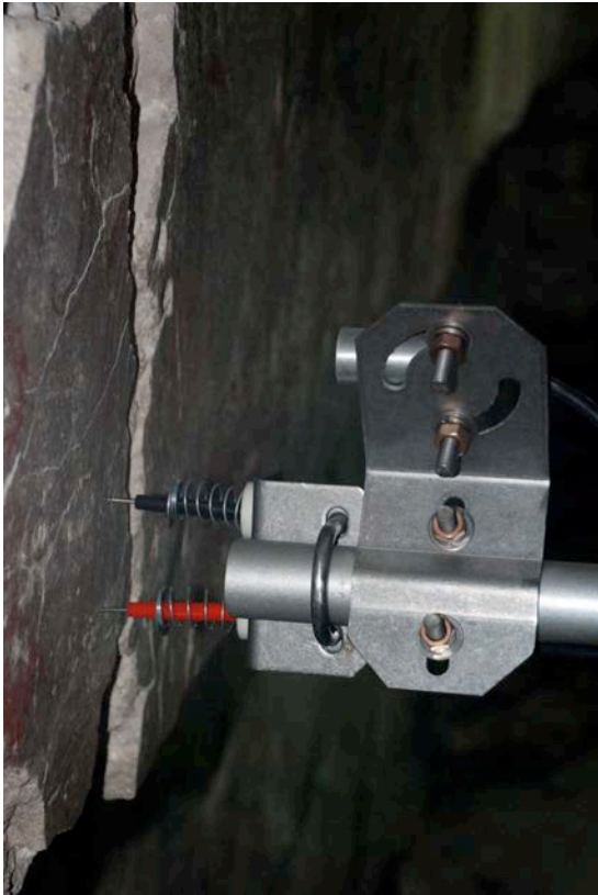
Fig.26 Sistema de control de movilidad y desplazamiento de los murales del cuarto de las pinturas. Se muestran las agujas colodas directamente sobre el estuco, hasta el momento no se ha resgistrado ninguna alteración en la superficie. Foto Romero 2011.
