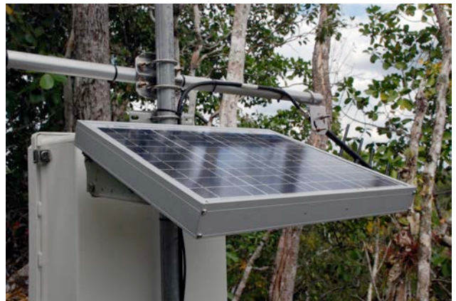
Fig. 27 Partes de la estación de monitoreo que fueron dañados con la caída de árboles, al momento han sido reintegrados y funcionan con normalidad. A la veleta se le desprendió la colilla de dirección y el panel fue desprendido de su base. No se alteró el funcionamiento del sistema. Fotos Romero 2011.
