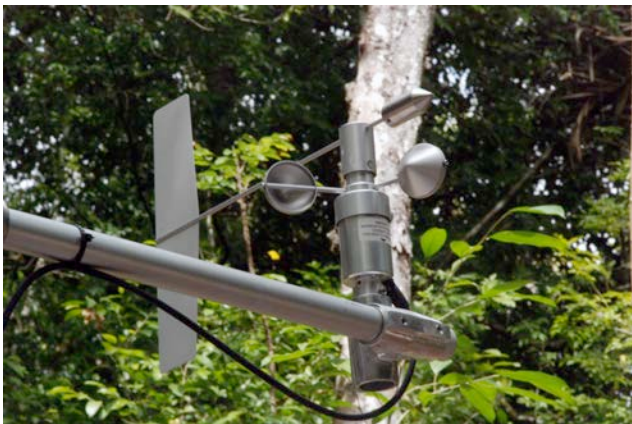
Fig. 27 Partes de la estación de monitoreo que fueron dañados con la caída de árboles, al momento han sido reintegrados y funcionan con normalidad. A la veleta se le desprendió la colilla de dirección y el panel fue desprendido de su base. No se alteró el funcionamiento del sistema. Fotos Romero 2011.
