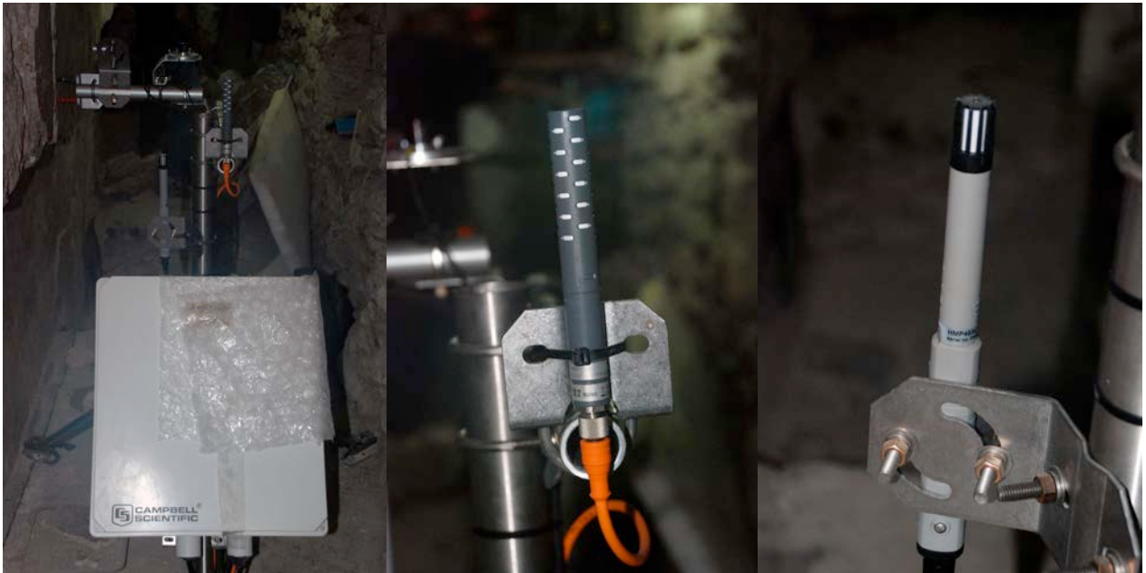
Fig.25 Sistema interno de control de humedad, temperatura, desplazamiento y movilidad colocado dentro del cuarto de las pinturas. Fotos Romero 2011
