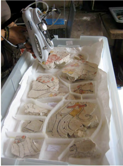
Figura 5 (izquierda). Utilizando la fluorescencia de rayos X con pedazos de Sub 1A. Figura 6 (derecha). Los fragmentos de mural re-embalaron en cajas de plástico y guardaron en el bodega del laboratorio.
